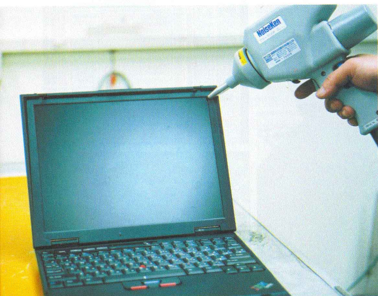
凡是銷往歐盟地區的電子產品必須通過八千伏的靜電防護測試，因此必須雙管齊下從工廠靜電防護與加強晶片的防靜電能力
